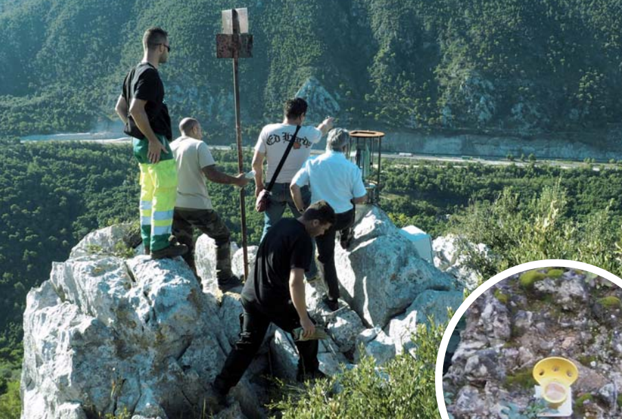
Un système d'auscultation a été installé au Plateau Tercier afin de mesurer les mouvements de terrain du versant du Vallon.
